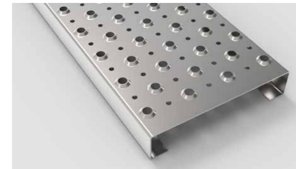
Type AP 2 - 50 met afwatering (MAW) (2 mm plaat) Type AP 3 - 50 met afwatering (MAW) (3 mm plaat) Antislipperforatie Ø 14 mm, h.o.h. 50 mm, hoog 4 mm. Afwateringsperforatie Ø 8 mm, h.o.h. 50 mm, vlak.
