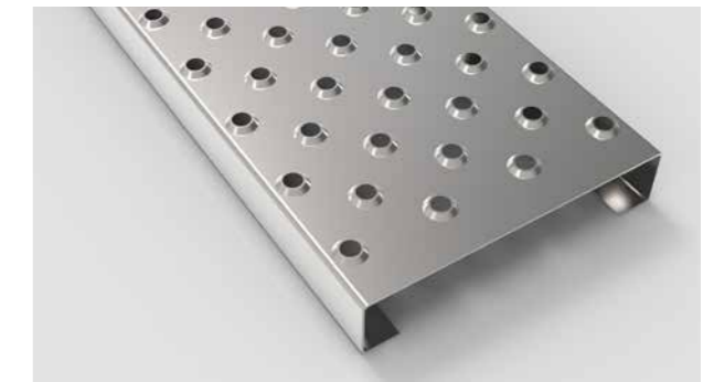
Type AP 2 - 50 zonder afwatering (ZAW) Type AP 3 - 50 zonder afwatering (ZAW) Antislipperforatie Ø 14 mm, h.o.h. 50 mm, hoog 4 mm. Geen afwateringsperforatie.
